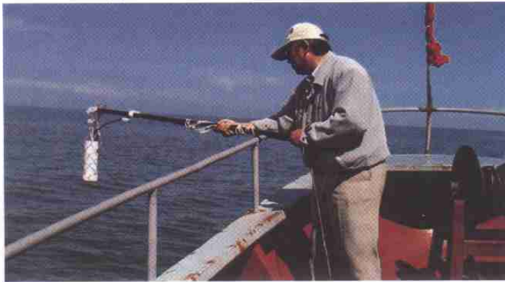
图 3 CE312 在青海湖水面测量水表热红外辐亮度
